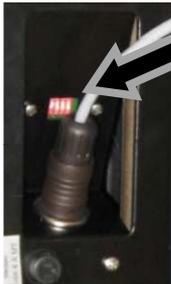
Auf der Unterseite des Displays befindet sich in der Nähe des Anschlusses für das Signalkabel ein Schalterfeld mit 4 „SWITCHES“, welches wir sicherheitshalber mit schwarzem Klebeband abgedeckt haben.
